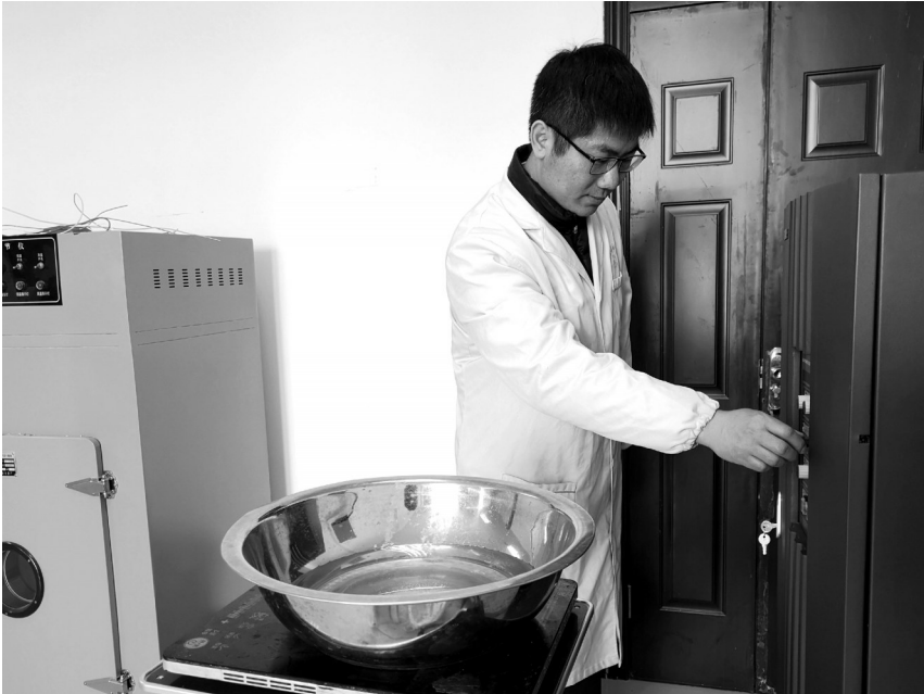
刁平华用标准电源系统检测电磁炉的最大输入功率。
