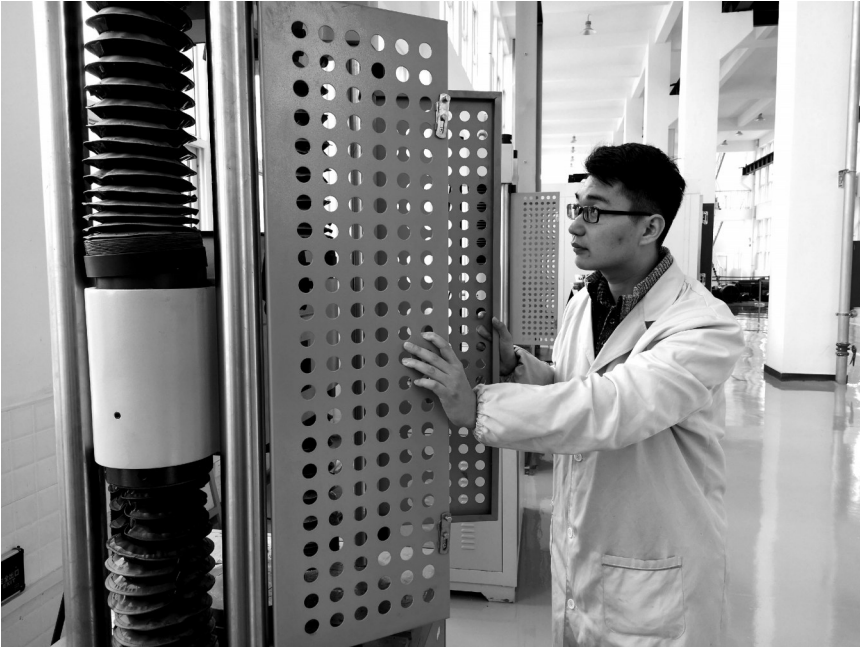
刘骞用万能材料试验机检测样品石材的压缩强度。
