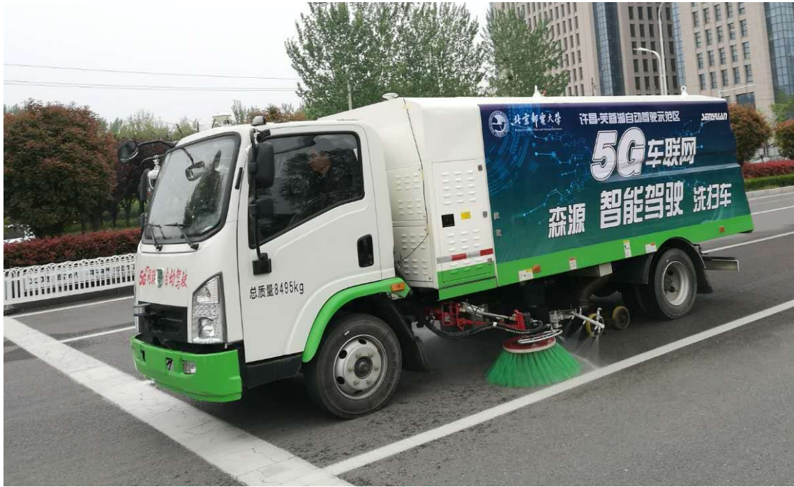
昨日 17 时,在许昌芙蓉湖自动驾驶示范区开展的 5G 自动驾驶清扫车首次作业试验取得成功。在试验过程中,车内的安全员全程未碰方向盘。
