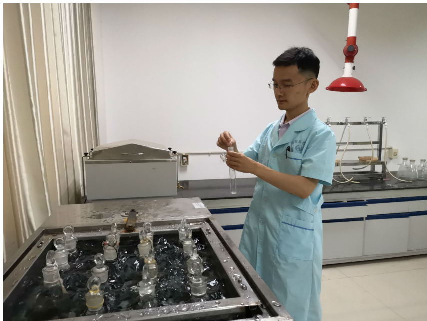
张毅将透明塑料桌垫碎块放入试管,准备进行超声波提取。
