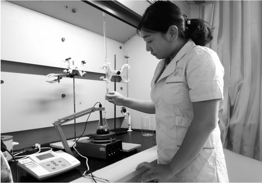
王阿敏用滴定法检测样品酱油的氨基酸态氮含量。
