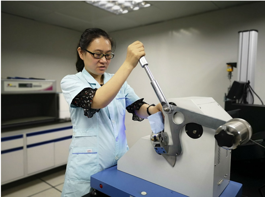
马瑞丽检测样品的撕破强度。
