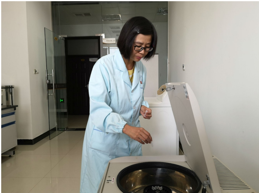
工程师田秀英将粉底液样品放入离心机,准备检测其稳定性。
