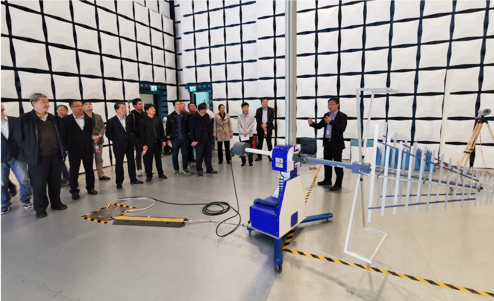
10月27日,参会嘉宾参观开普检测电磁兼容试验研究中心10米法电波暗室。长22.5米、宽16.5米、高8米的超大空间让人格外震撼。记者 陈晨 摄
