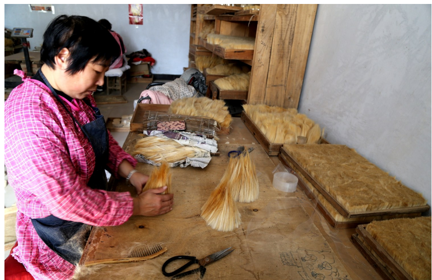
尾毛加工精细复杂,要经过剪、洗、涮、晒等工序。 许昌报业全媒体记者 陈晨 摄
