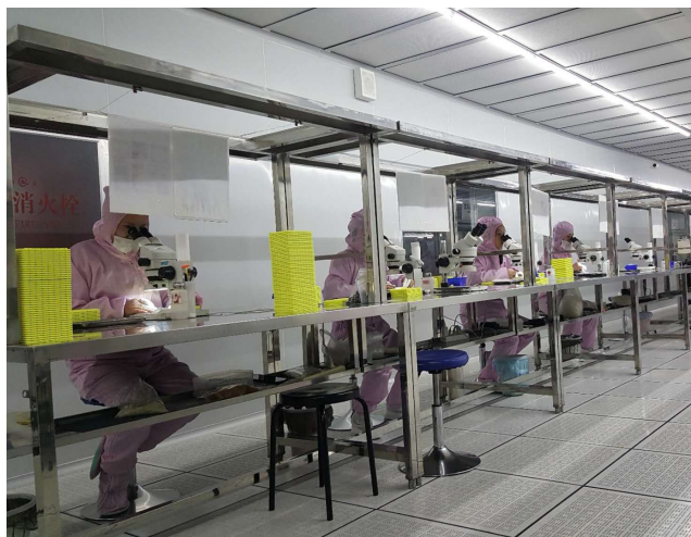
百级无尘车间内的VCM性能测试线 记者 代玺 摄
