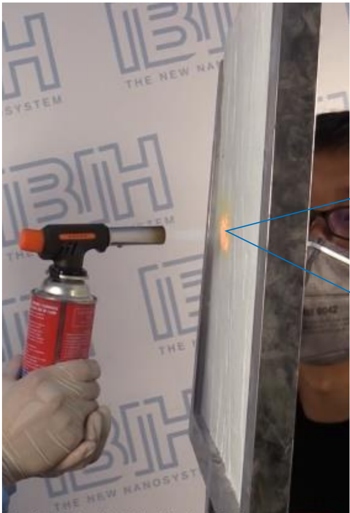
左图:气凝胶隔热片实验 右图:气凝胶实物 记者 肖涛 摄
