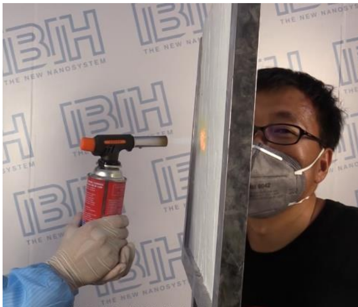
爱彼爱和工作人员进行气凝胶隔热片实验。
