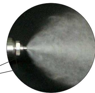
雾化喷嘴可以将高压下的液体以雾化的形式喷出，均匀悬浮于空气中。雾化颗粒直径一般为15—60微米
