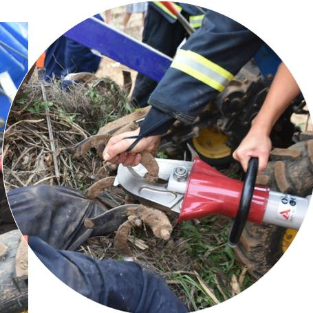
↑ 消防员用液压剪切钳将旋耕机刀片剪断。
