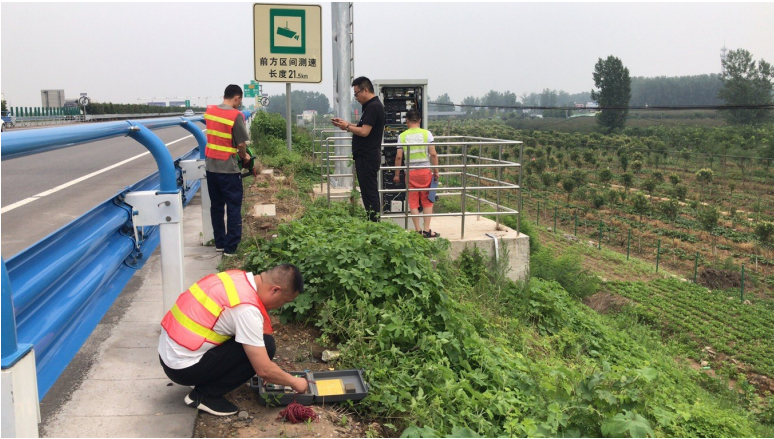
2019年夏,工作人员对高速公路旁的防雷设备进行检测。 图片由市气象局气象灾害防御技术中心提供
