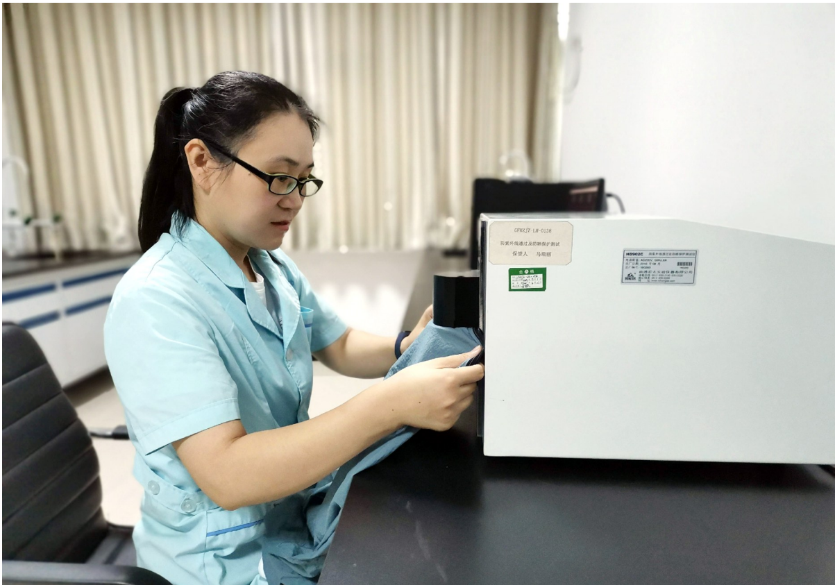
马瑞丽检测样品防晒服的防紫外线能力。
