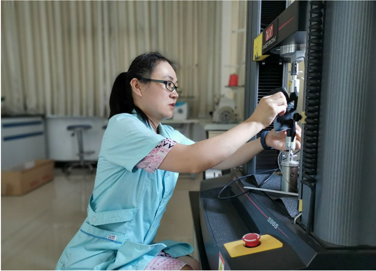
馬瑞麗用拉力試驗機檢測樣品的縫合強度。
