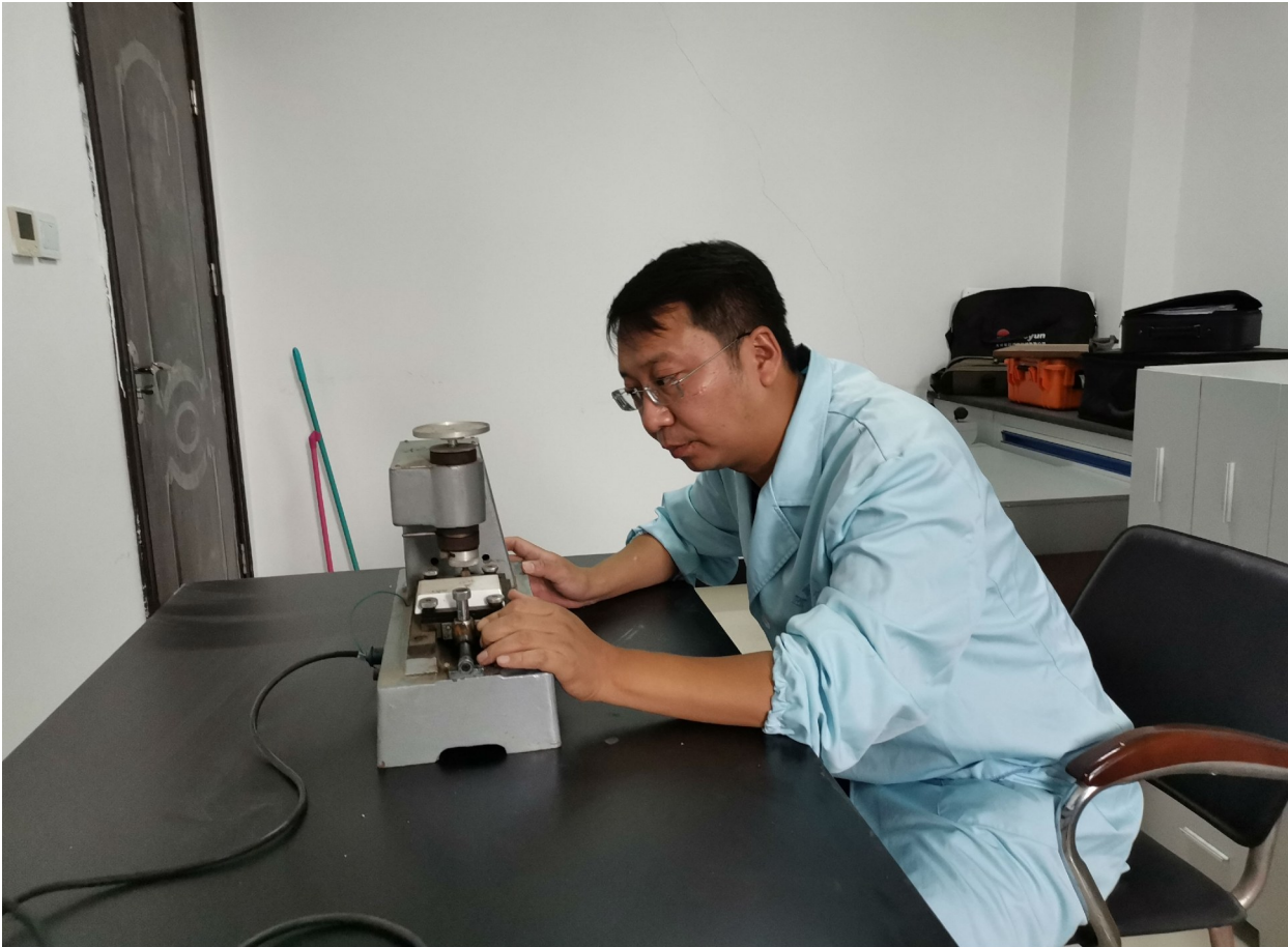
穆浩用漆膜磨耗仪检测样品的漆膜耐磨性。
