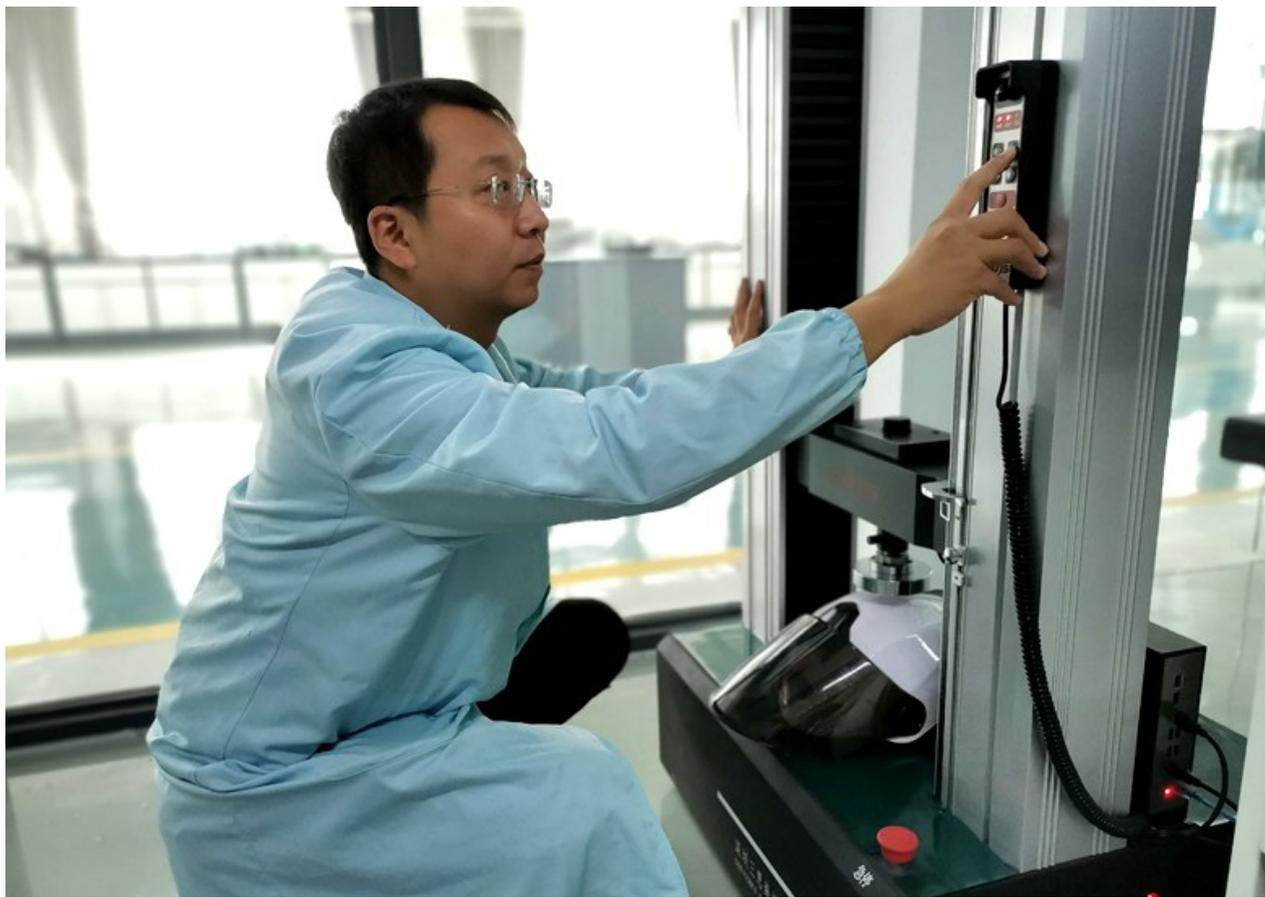
穆浩用万能材料试验机检测样品的刚度性能。
