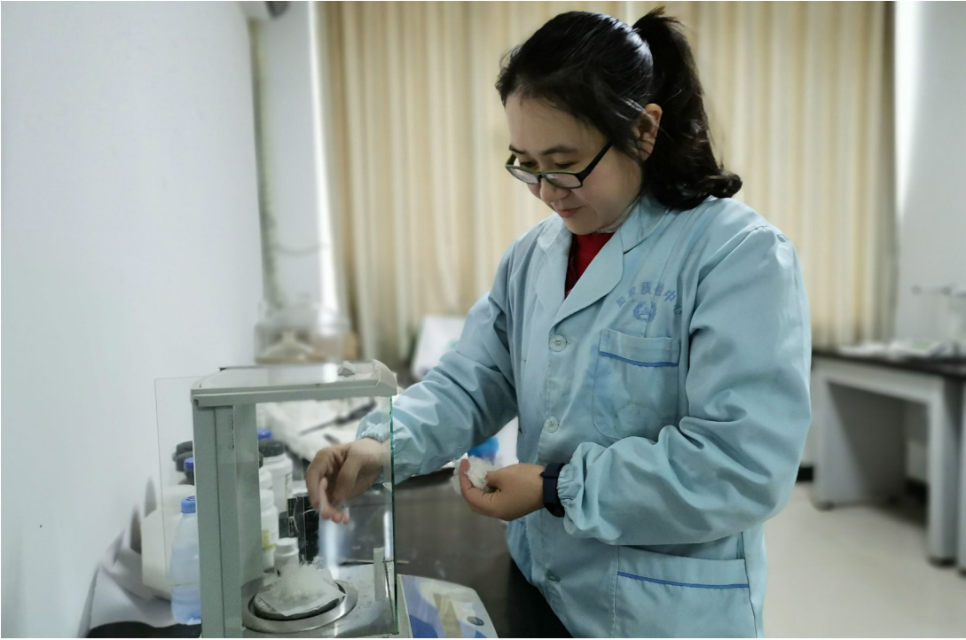
马瑞丽用天平称取羽绒,准备进行含绒量检测。
