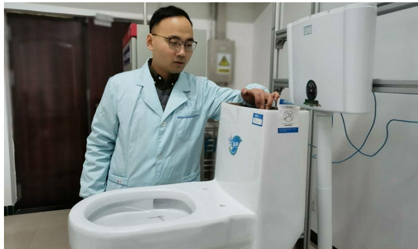
任可用使用卫生陶瓷冲洗功能试验机检测样品的节水性能。
