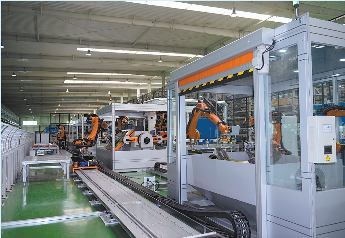
近年来,我市不断推进制造业智能化改造,图为森源集团钣金柔性生产线
