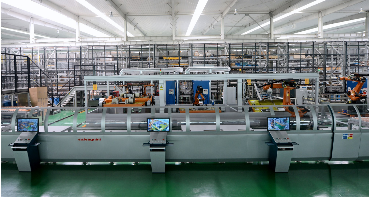
森源电气不断加大两化融合力度,图为该公司的钣金柔性生产线。
