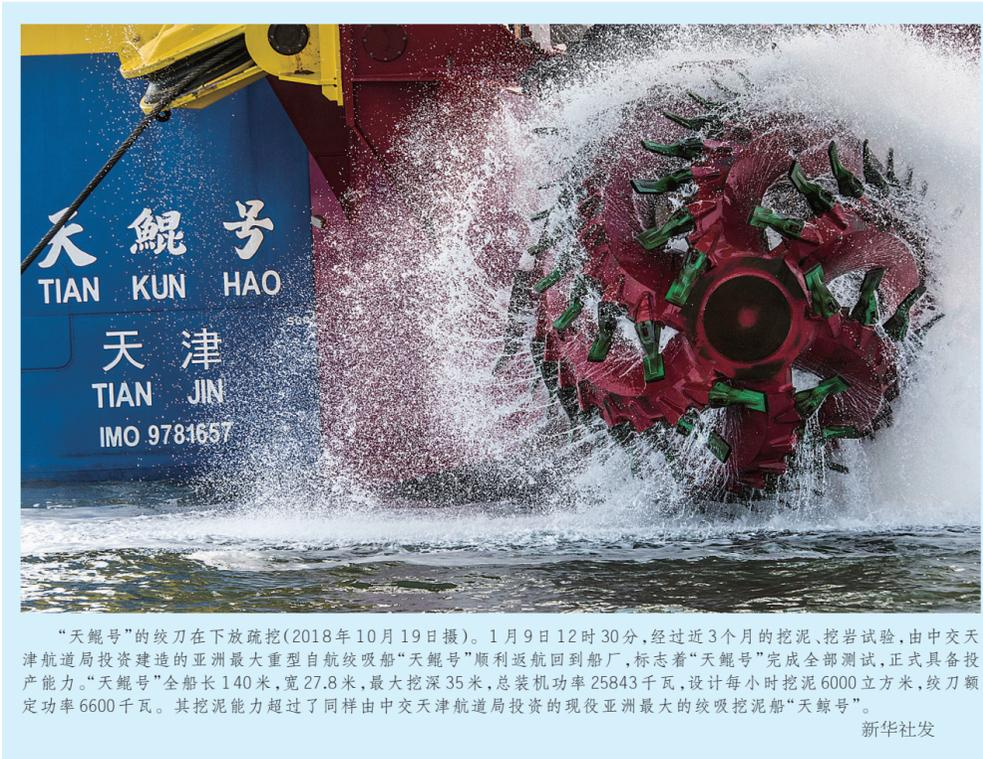
“天鲲号”的绞刀在下放疏挖(2018年10月19日摄)。1月9日12时30分,经过近3个月的挖泥、挖岩试验,由中交天津航道局投资建造的亚洲最大自航绞吸船“天鲲号”顺利返回到船厂,标志着“天鲲号”完成全部测试,正式具备投产能力。“天鲲号”全船长140米,宽27.8米,最大挖深35米,总装机功率25843千瓦,设计每小时挖泥6000立方米,绞刀额定功率6600千瓦。其挖泥能力超过了同样由中交天津航道局投资的现役亚洲最大的绞吸挖泥船“天鲸号”。
