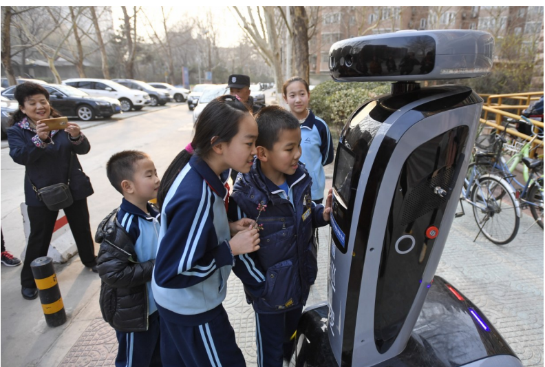
3月19日，智能巡防机器人“梅宝”吸引梅园社区的孩子们围观。近日，一台名叫“梅宝”的智能巡防机器人在北京市丰台区东高地街道梅园社区落户，开始执行社区巡逻任务。这台被居民称为“机器人探长”的智能机器人由北京航天自动控制研究所研制，可在社区内进行陌生人识别预警、视频信息采集、热成像火情识别、居民生活服务提示、人机互动交流、夜间巡逻安保等众多服务。
