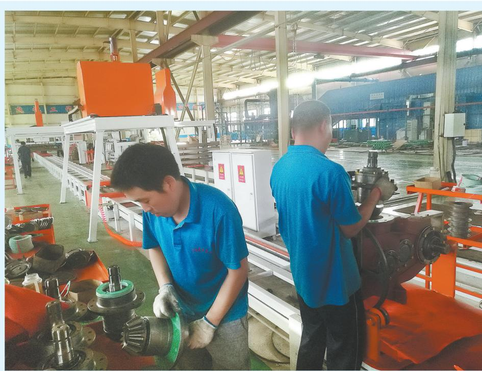
8月14日,河南蒙丰农业装备有限公司的工人们在旋耕机流水作业线上忙碌着。据悉,该条生产线是该公司自主研发的我国首条旋耕机装配自动化流水作业线。 魏东雅 摄
