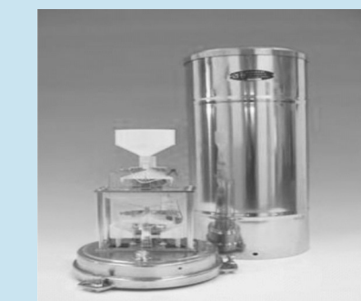
▲20世纪70年代末双翻斗式雨量传感器 ▲现代化观测设备筑牢气象高质量发展基础
