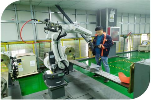
在许昌恩诺格生产车间内,工作人员正在设定焊接机器人的运行程序
