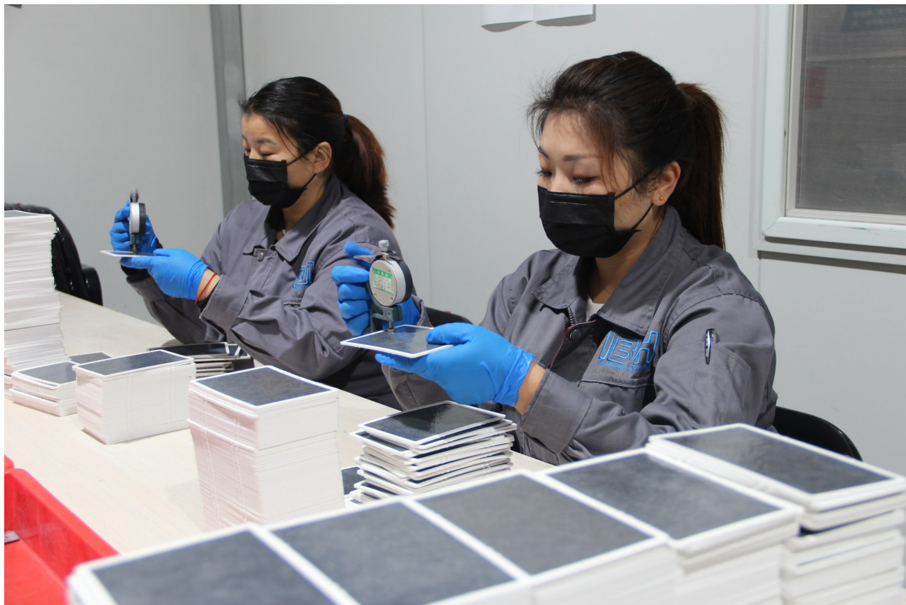
图为11月22日,河南爱彼爱和新材料有限公司的质检人员正在对该公司生产的动力电池隔热垫片进行出厂检验。该公司是一家集研发、生产、销售防火绝热和节能先进材料于一体的高科技企业,掌握气凝胶工业化生产的核心技术,已取得及正在申请的专利共20余项,可为用户提供纳米气凝胶复合材料及生产方案。魏东雅 摄
