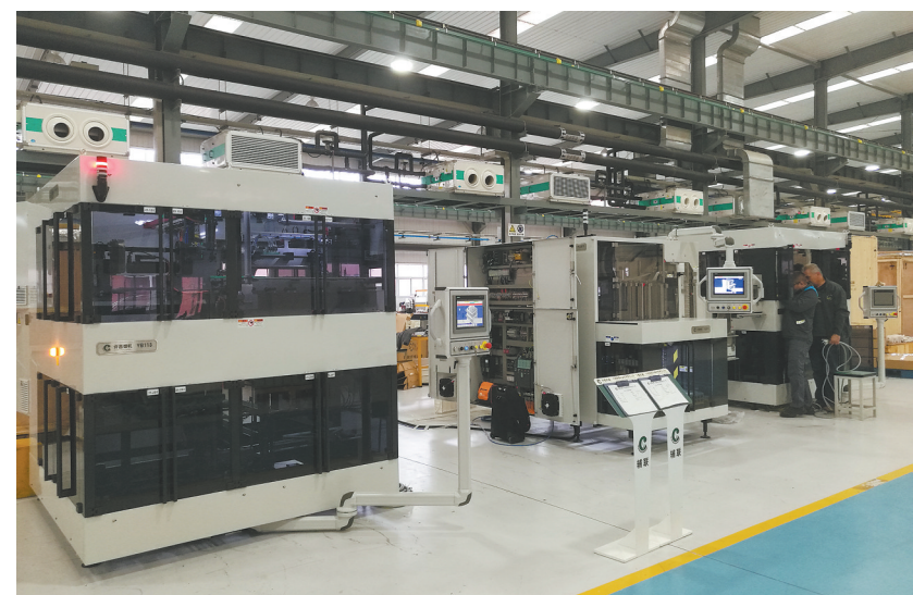
今年下半年,许昌烟草机械有限责任公司从荷兰ITM公司引进了分隔式装卸盘机,目前已装配完成,正在进行调试,预计近期调试完毕,达到交付使用条件。图为11月27日,荷兰ITM公司的技术人员正在对该设备进行调试。魏东雅 摄
