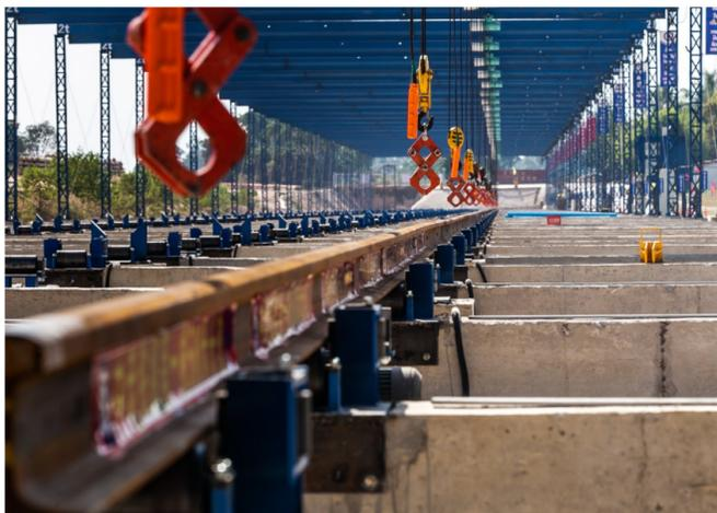
12月2日是老挝国庆节。当天,中老铁路首根500米钢轨在位于老挝首都万象的中铁二局焊轨基地完成焊接“出炉”,标志着中老铁路焊轨基地正式投入生产,为中老铁路全线轨道铺设奠定了坚实基础。
