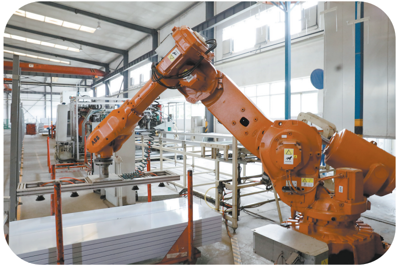
12月25日,西继迅达(许昌)有限公司智能机器人正在加工电梯配件。该公司通过引进机器人智能化生产线,不仅提升了生产效率,而且降低了人工生产成本。
