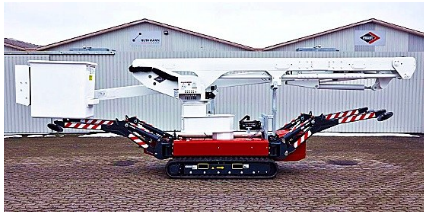
许继时代研发的新型智能化VST-52-I型履带式绝缘斗臂车
