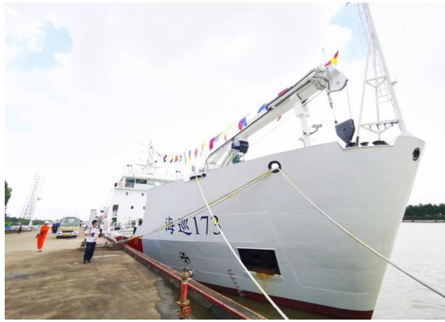
“海巡173轮”停靠在广州航标处仑头基地(7月22日摄)。“海巡173轮”7月22日正式列编交通运输部南海航海保障中心广州航标处。这艘排水量2228吨的大型航标工作船是中国交通运输系统南海海区装备最先进的船,将用于粤港澳大湾区和南海海区水上浮标的布设和维护。
