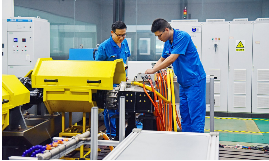
工作人员正在进行新能源汽车大功率高可靠三相异步电机的高速运转操作。
