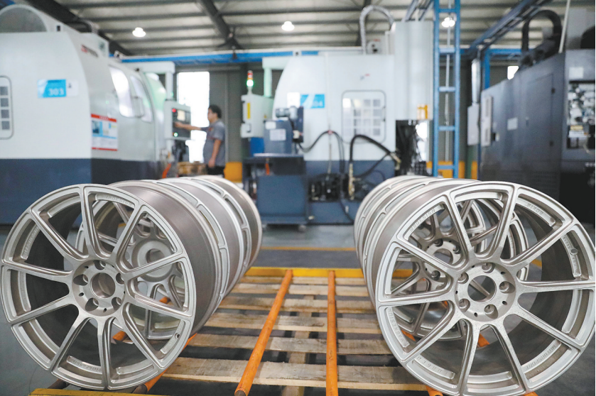
8月11日，在位于长葛市大周再生金属循环产业集聚区的德威科技股份有限公司，员工正在汽车轮毂生产线上忙碌。该公司的镁合金轮毂一次正反挤压锻造工艺领先同行业3至5年。
