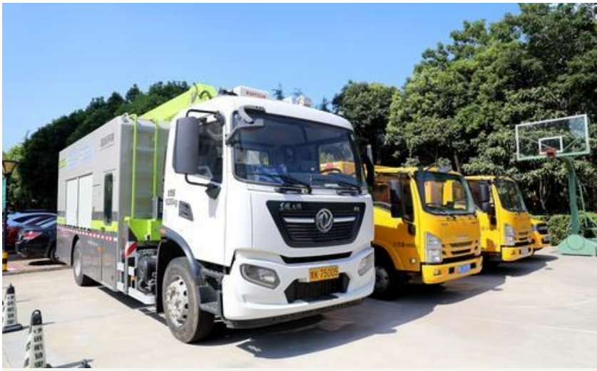
新增排水泵车，提升应急处置能力。
