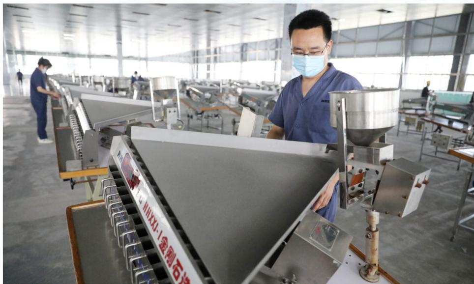
8月30日,黄河旋风股份有限公司员工正在安装调试金刚石筛选设备。该公司聚焦超硬材料,通过技术创新,自行研发超高压合成装备及大单晶合成制造工艺技术等,形成年产培育钻石320万克拉的生产能力,产品性能达到国际先进水平。
