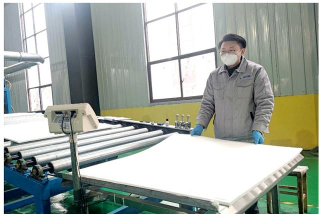
在特种纤维生产车间里,工人们加紧生产高性能陶瓷纤维衬垫
