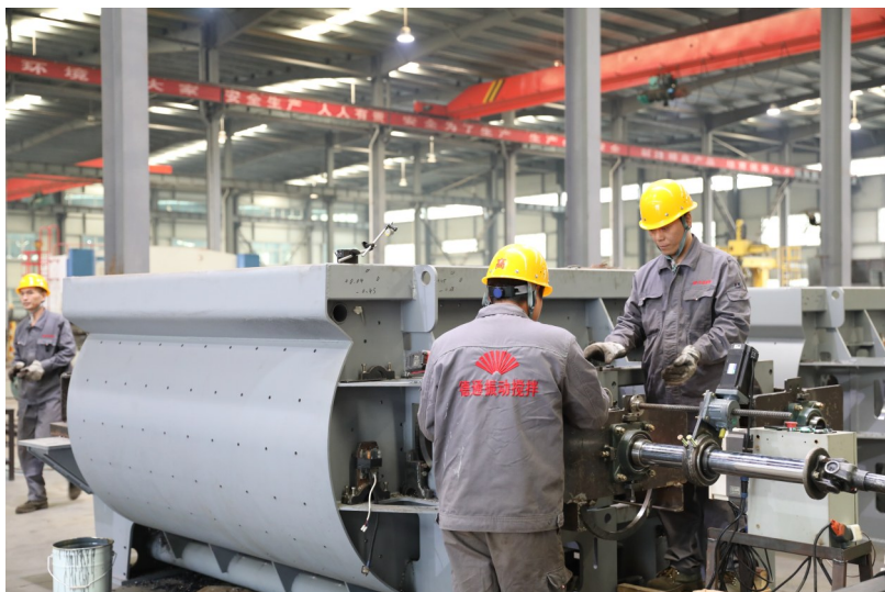
10月16日,许昌德通振动搅拌科技股份有限公司员工正在生产组装振动搅拌装备。
