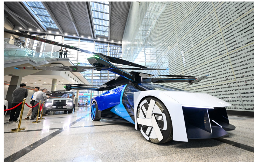
11月15日，在第二十五届高交会上，机臂、旋翼等飞行系统可以完全折叠收纳的小鹏汇天陆空一体式飞行汽车对公众展出。
