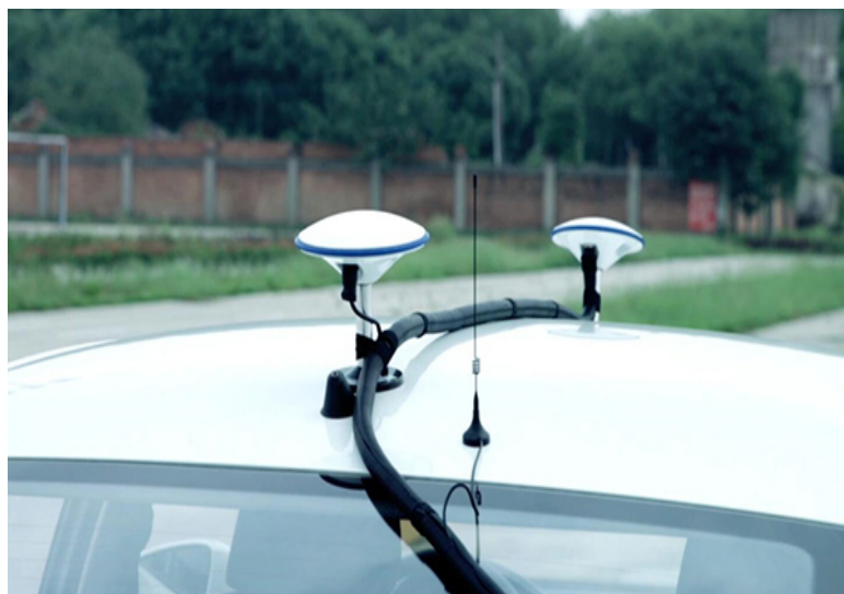
在车顶上安置了卫星信号接收器。
