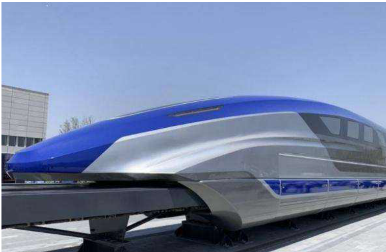
设计时速 600 公里的高速磁悬浮列车实车。
