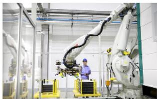
工人在调试电力屏柜生产线上的机器人。 乔利峰 摄
